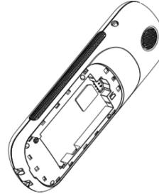
2. Inserte la batería y reemplace la cubierta trasera.
