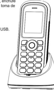
• No retire la batería antes de desconectar el cable micro USB. Hacer esto puede causar daños al teléfono.
